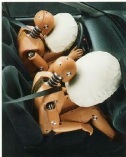
Een elektronische sensor houdt voortdurend de vertraging van de auto onder controle om ervoor te zorgen dat het airbag-systeem uitsluitend wordt geactiveerd bij een flinke botsing.
