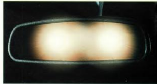
De zelfdimmende achteruitkijkspiegel stelt automatisch bij om verblinding te voorkomen door felle verlichting van achteropkomende auto's.
