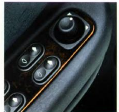
Door Multiplex is er aanzienlijk minder bedrading nodig. Doordachte positionering van de modules maakt het mogelijk de schakelaars overzichtelijker te plaatsen.
