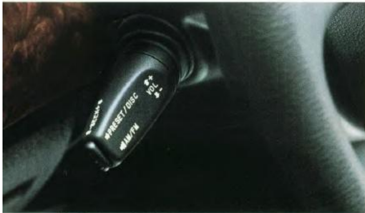
Met de nieuwe afstandsbediening kan de bestuurder het audiosysteem bedienen zonder zijn ogen van de weg te nemen of zijn handen van het stuur te halen.
